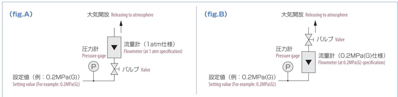
**注意** MPa各圧力単位の後の(G)とは、ゲージ圧を表す略称です。流量計本体には略称を表示いたします。
